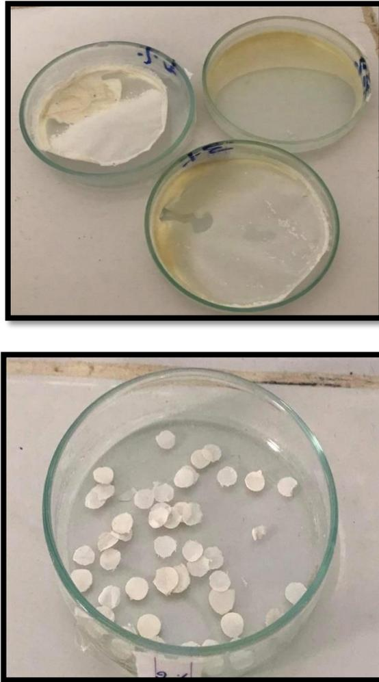
**Figure n°04** : Etapes de préparation d'un film de PHBV
