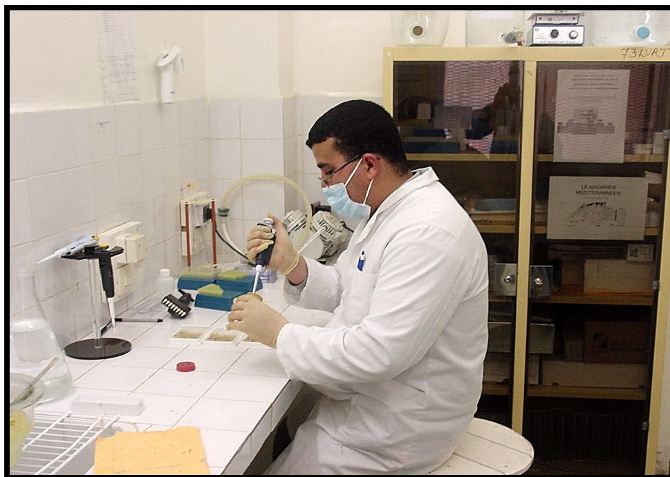
Photo 08: Distribution des échantillons à tester à l'aide d'une micropipette de précision à un canal.
