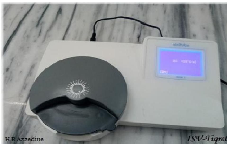
*Figure 18: La détermination de la concentration à l'aide d'un photomètre Minitube(2019).*
