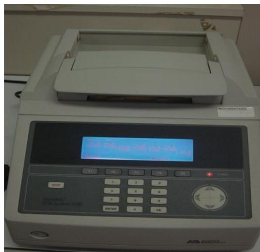
**Annexe 11 :** Thermocycleur : appareil automatisant la réaction de PCR classique
