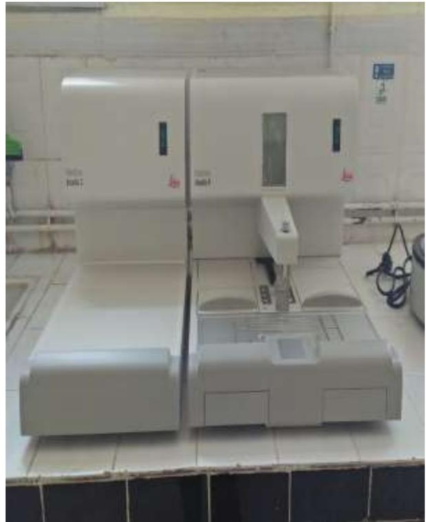
**Figure 19 :** Station d'enrobage LEICA Arcadia C 2615 et Arcadia H 2224
