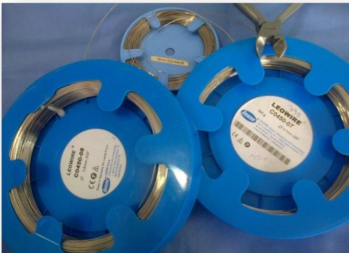
**Figure N° VI-4** Photographie montrant une bobine de fil métallique inoxydable de différents diamètres.
