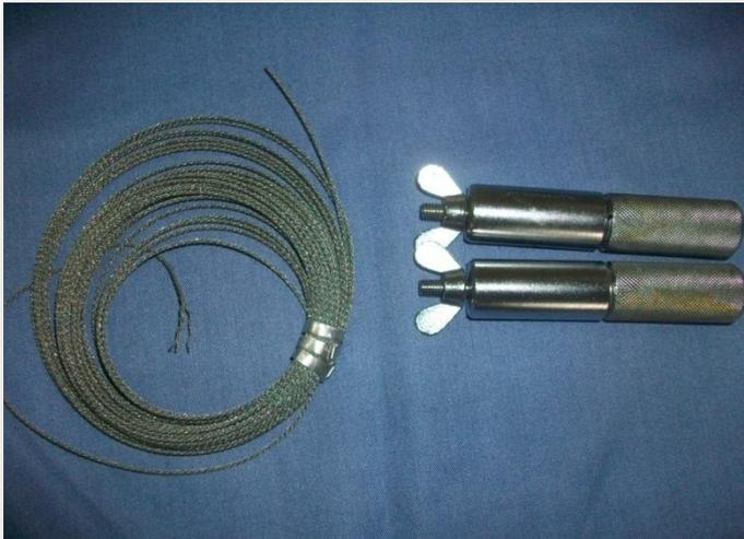
**Figure N° V-3 :** Photographie montrant une scie fil inoxydable avec ses poignées.
