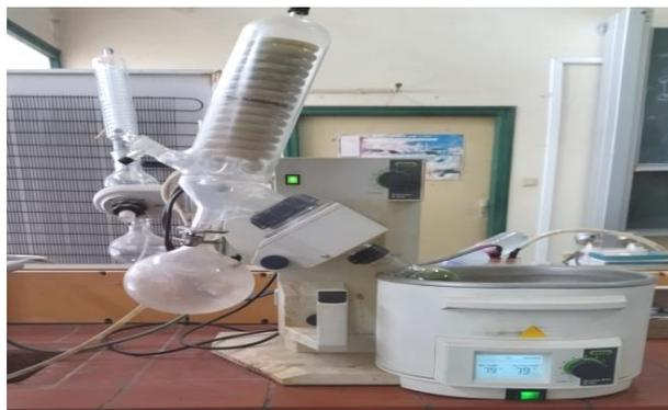
Figure II.10 : Rotavapeur utilisé pour l'évaporation du Méthanol.
