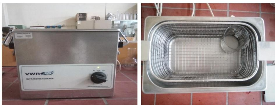
*Figure II.6 : L'appareil ultrasons (VWR).*
