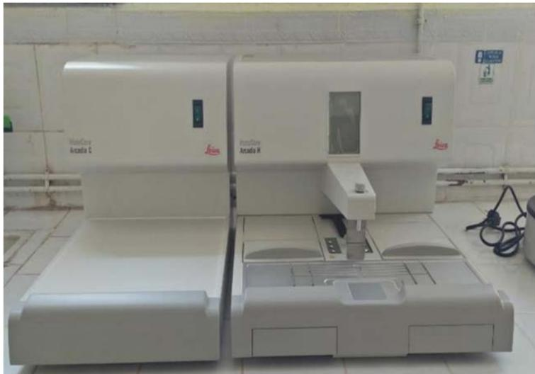
**Figure 21.** Station d'enrobage LEICA Arcadia C 2615 et Arcadia H 2224.
