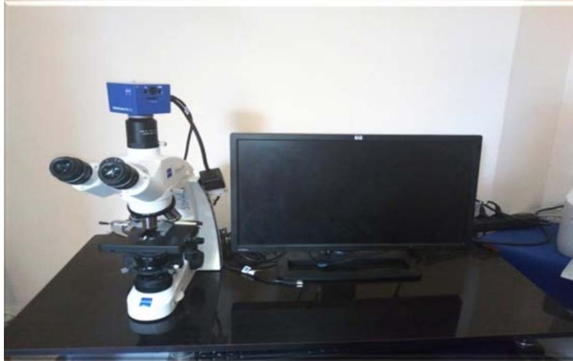
**Figure 25.**Microscope optique (ZEISS) lié à une caméra (ZEISS Axio Cam ERc 5s)
