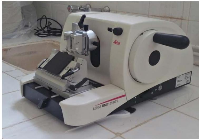
**Figure 22.**Microtomerotatif de type LEICA2125.
