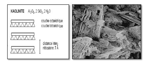
**Figure.I.4.** Image au microscope électronique de plaquettes d'argiles (kaolinite) de quelques microns (1 micron = 0,001 mm) [9]
