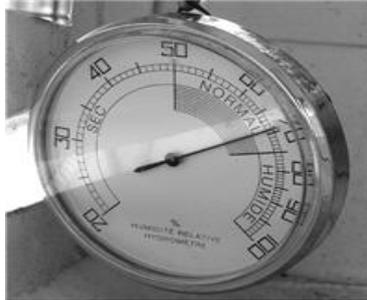
Figure III.8 : Hygromètre à cheveux.
