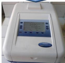
Analyse par spectrophotomètre UV-visible
