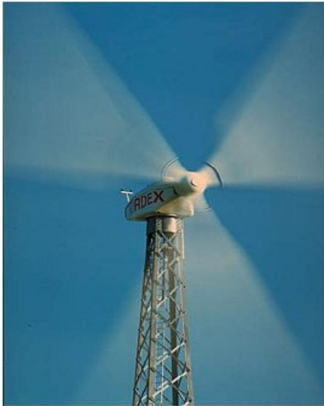
Fig 1.4 Eolienne à axe horizontale
