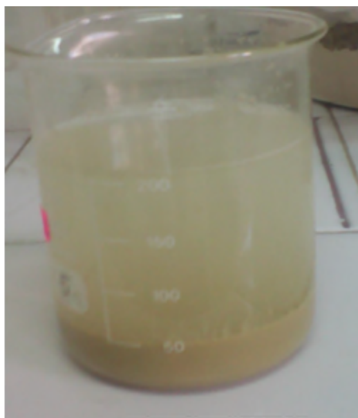
Figure I.10 : Mise en suspension de l'argile à traiter
