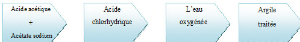
Figure I.14 : Les différentes étapes du traitement chimique.
