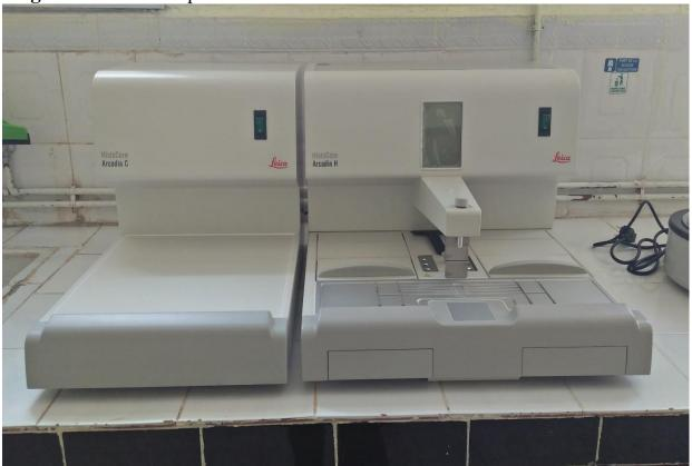
Figure 40: Centre d'enrobage LEICA Arcadia C 2615 et Arcadia H 2224
