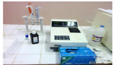
Figure 16: spectrophotomètres
