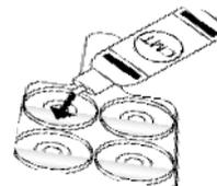
2) Ajoutez un volume de réactif équivalent à la quantité de lait en remplissant le godet jusqu'au cercle central.
