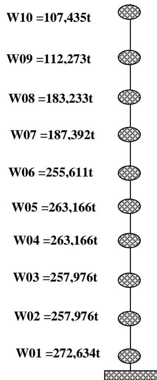
**Figure IV.01** Concentration des masses sismiques sur la hauteur
