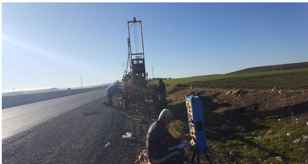
**Figure 5.1** :Sondage pressiométrique
