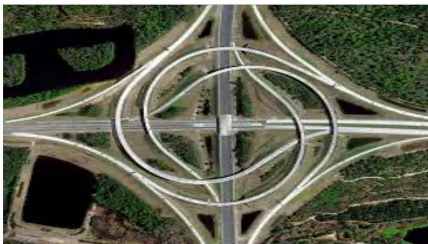
**Figure 2.4 :** Échangeur en turbine complète
