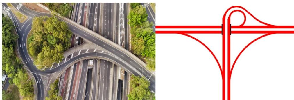
**Figure 2.2 :** Échangeur en trompette
