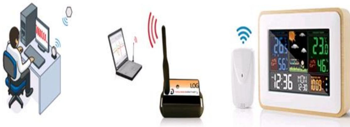
Figure 4: Enregistreurs de données à capteurs sans fil
