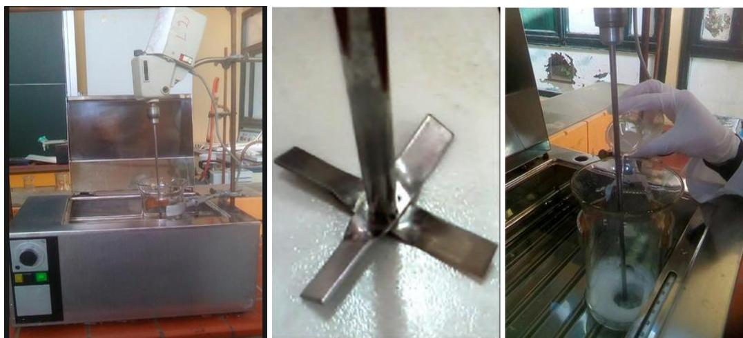
**Figure 17 :** Dispositif Expérimental de la microencapsulation par évaporation de solvant.
