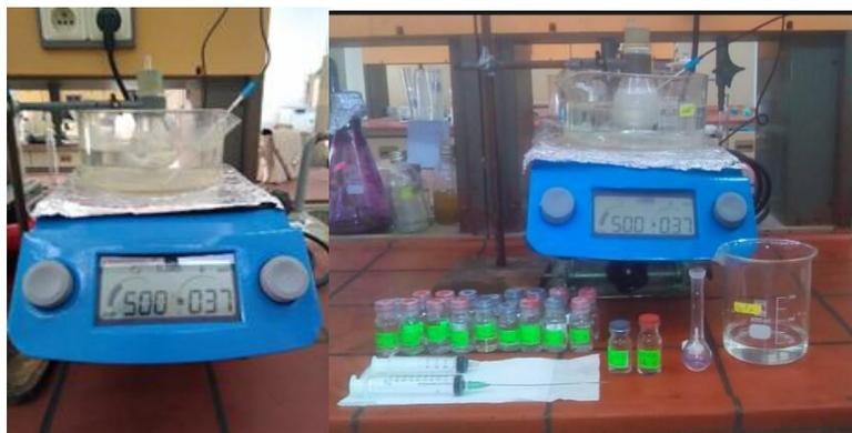
**Figure 18 :** Dispositif expérimental de la libération de principe actif.
