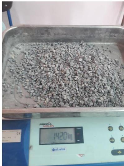
**Figure (III.14) :** Détermination de la masse volumique de gravier
