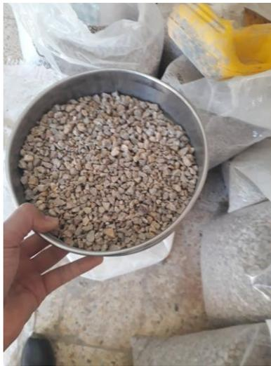
**Figure (III.13) :** Essai de la masse volumique du gravier 3/8 et 8/15
