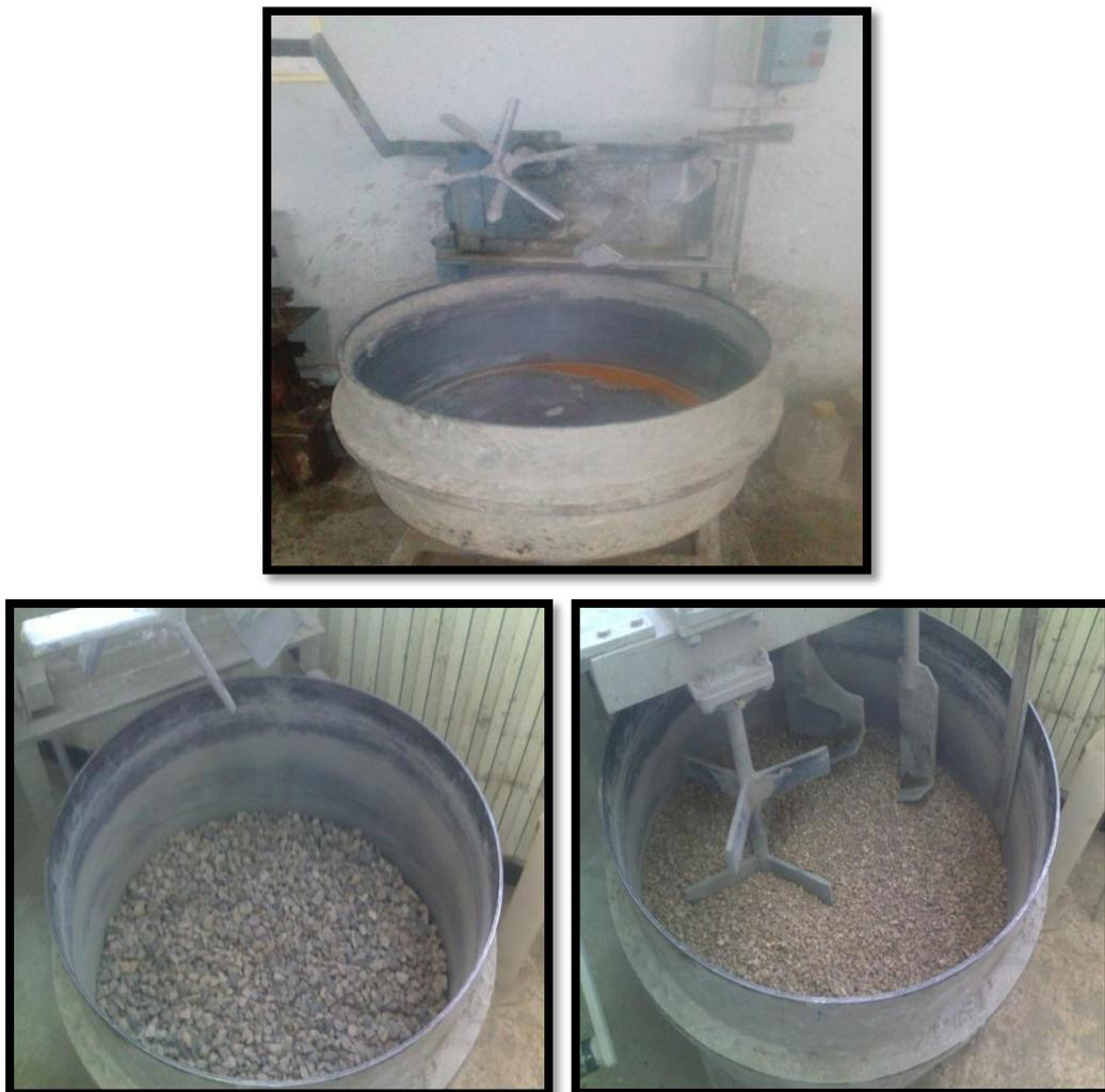
**Figure (III.23) :**Introduction des constituants dans le malaxeur du béton
