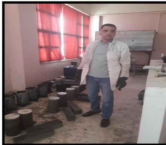
**Figure(III.29) :** Démoulage des éprouvettes cylindriques et prismatiques
