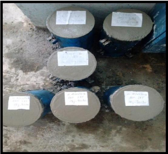
Figure (III.28):Préparation des éprouvettes Cylindriques
