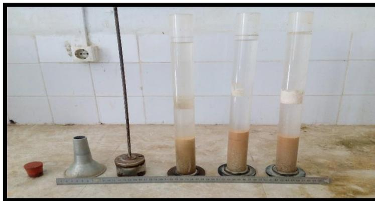
**Figure (III.9) :**Essai d'équivalent de sable (juste après agitation)
