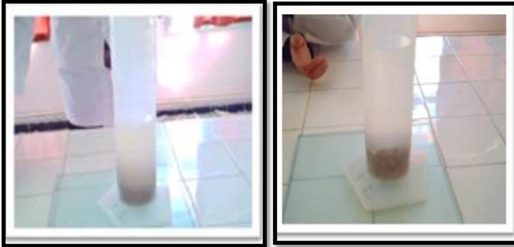
**Figure (III.15):** Détermination de la masse spécifique de gravier
