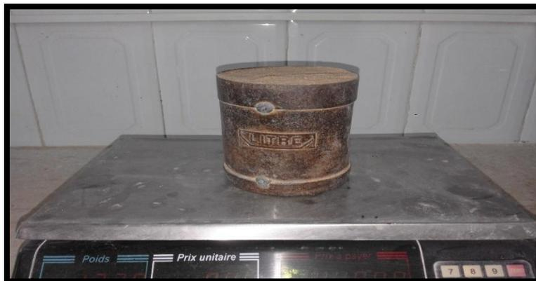
**Figure (III.5) :** Détermination des masses volumiques et spécifiques
