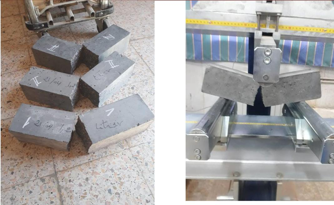
**Figure (III.35) :** Rupture des éprouvettes prismatiques (Béton HPL)
