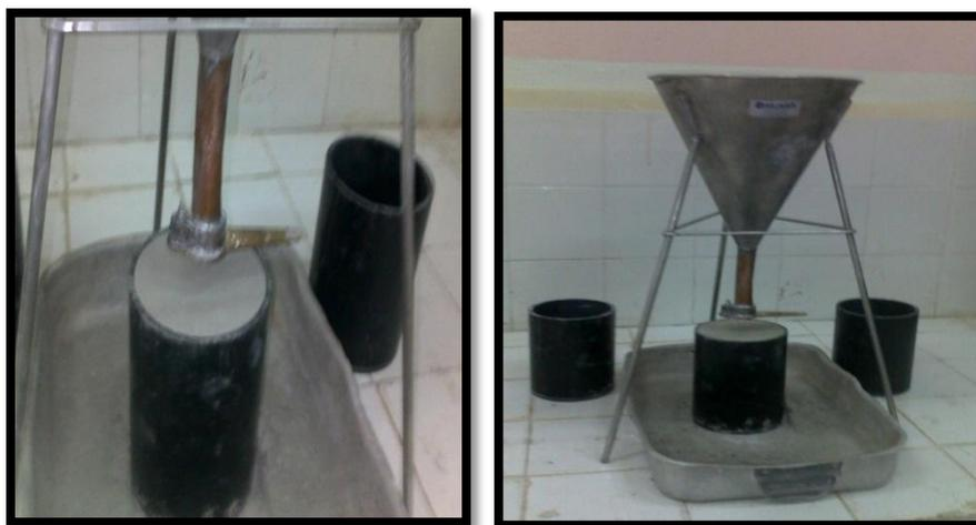
**Figure (III.2) : Détermination de la masse volumique**
