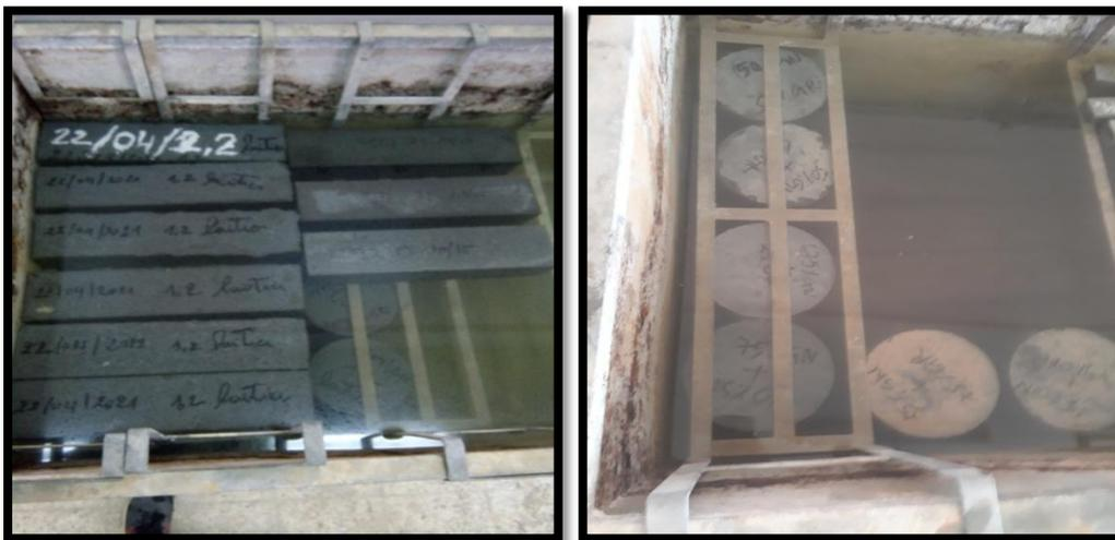
Figure (III.31) : Conservation des éprouvettes cylindriques et prismatiques dans l'eau à 20 °C
