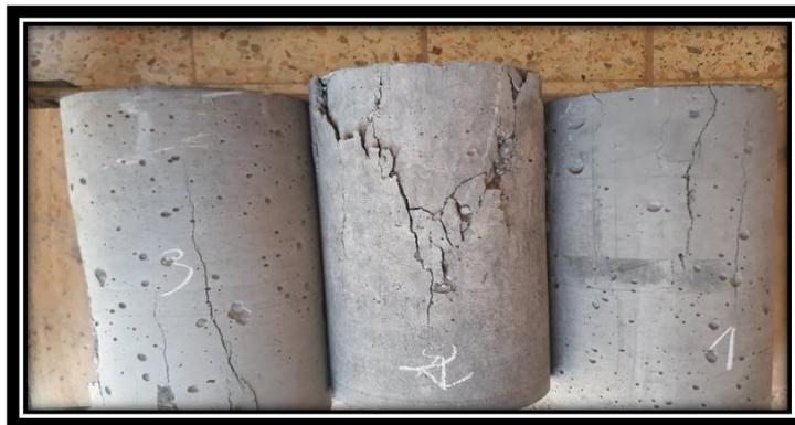
**Figure(III.33):**Rupture des éprouvettes cylindriques BHPL
