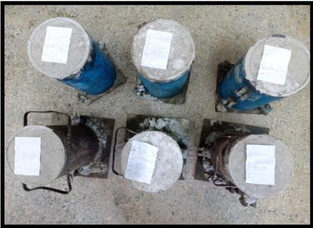
Figure (III.27) :Moulage des éprouvettes cylindriques
