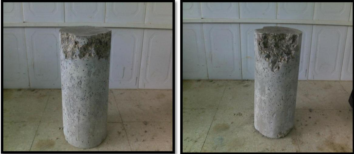
**Figure (III.34):**Rupture des éprouvettes cylindriques à 28 jours Béton à haute performance BHPLR
