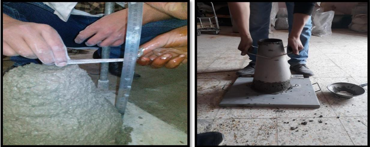
Figure (III.26) :Mesure de l'affaissement du béton
