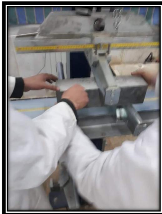
**Figure (III.34) :** Chargement des éprouvettes prismatiques pour l'essai de traction
