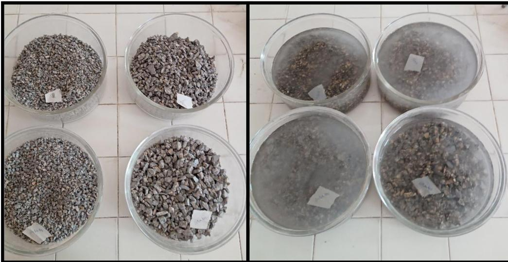
Figure (III.16) l'échantillon imbibé dans l'eau 24h
