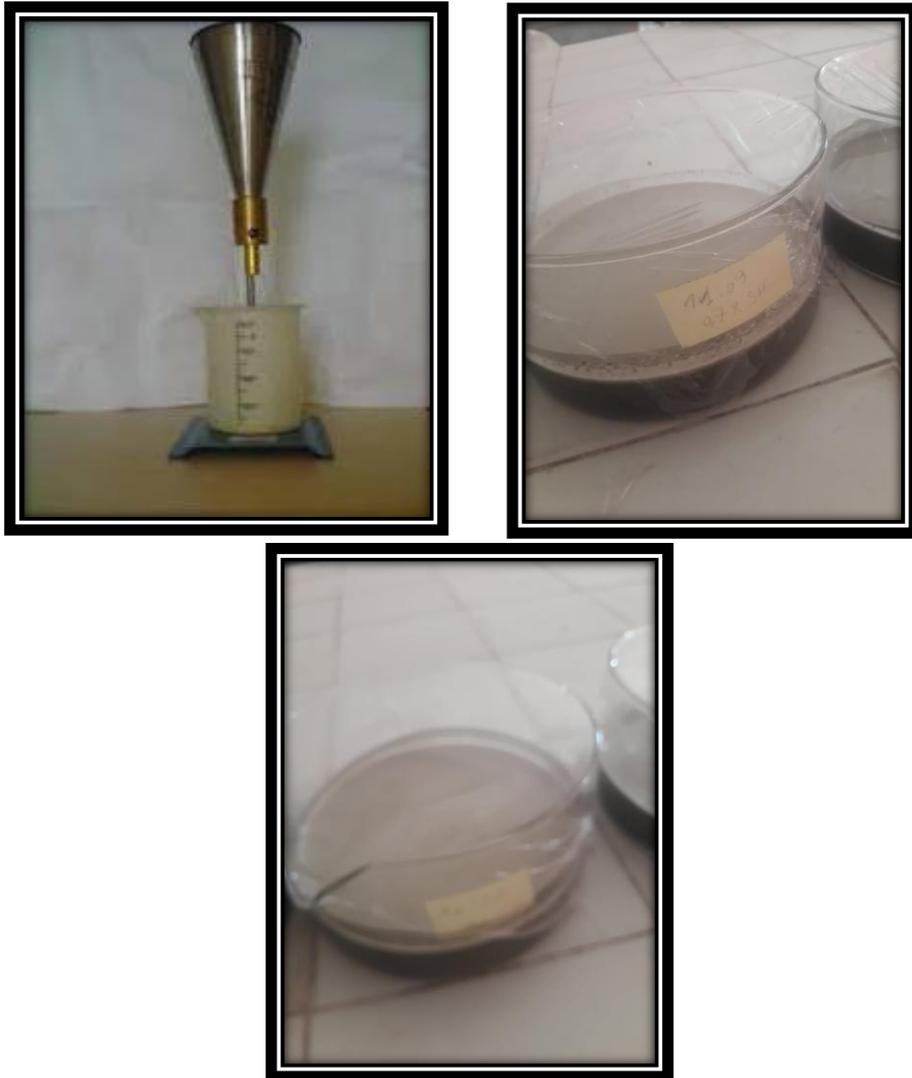
**Figure (III.21) :** Ecoulement au cône de Marsh et préparation des coulis
