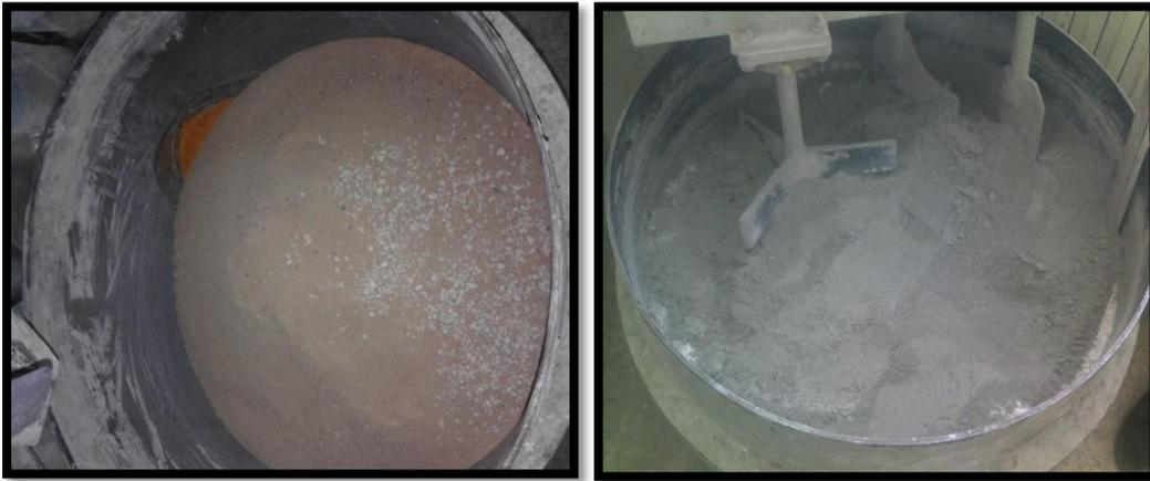
**Figure (III.24) :** Malaxage à sec des ingrédients du béton
