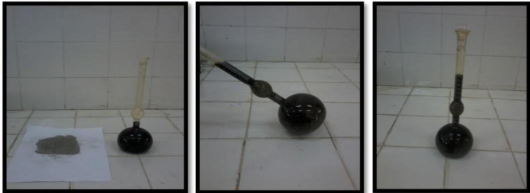
Figure (III.3): Détermination de masse volumique absolue
