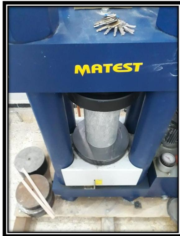
**Figure (III.32) :** Chargements des éprouvettes cylindriques 16x32 cm (Essai de compression)
