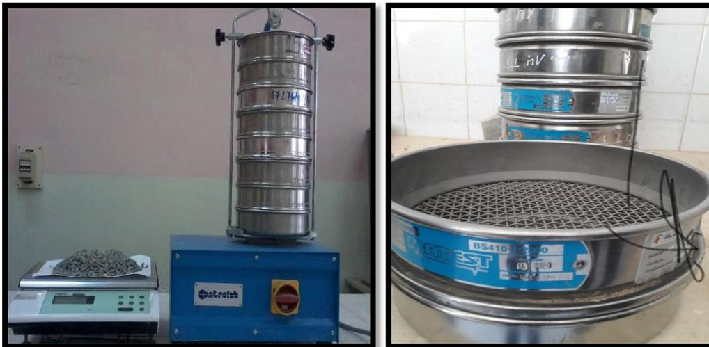
**Figure (III.12) :** Essai d'analyse granulométrique
