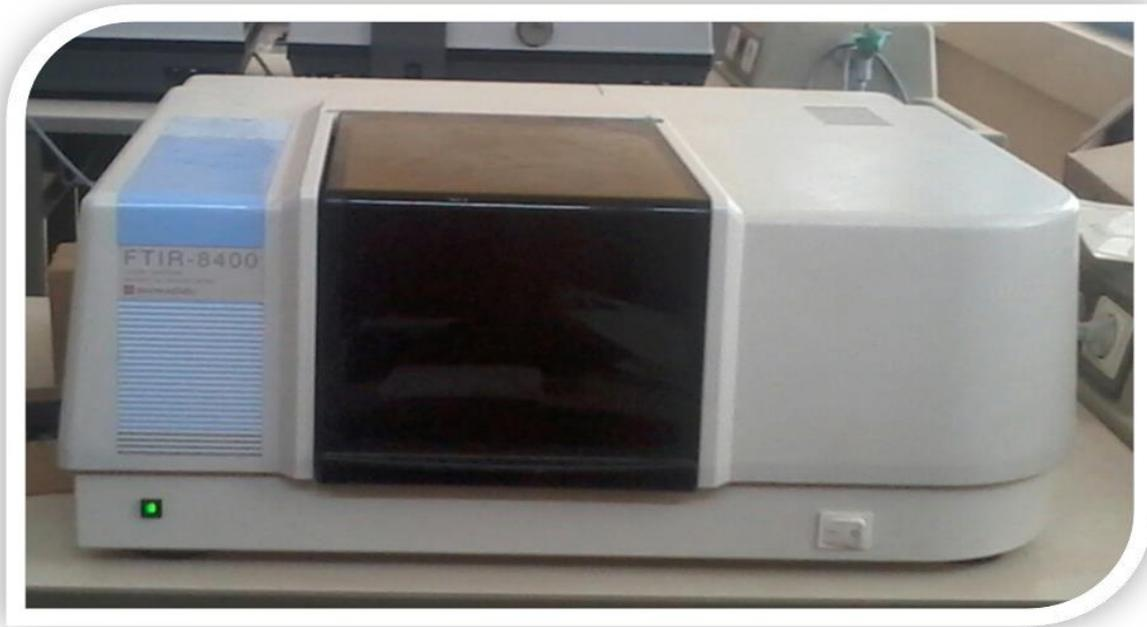
Figure III.10. Spectroscopie infrarouge FTIR-8400.
