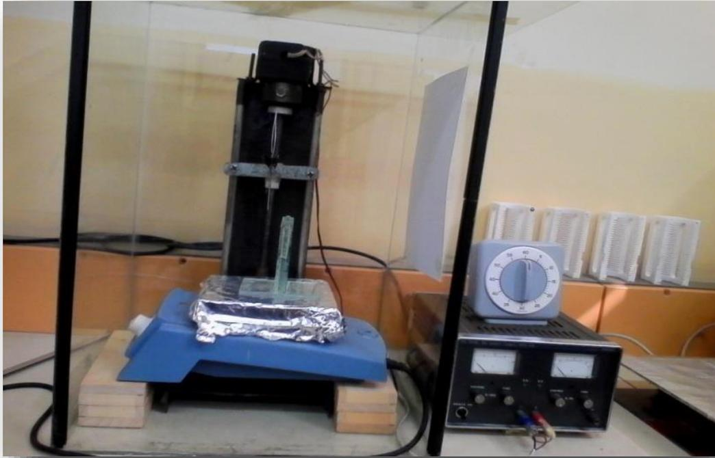
**Figure IV.3.** Dispositif de dépôt des couches minces par la technique dip-coating.
