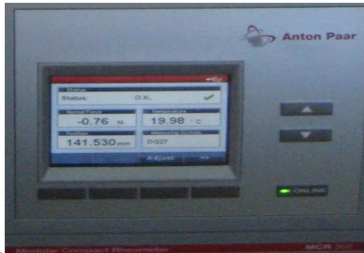
Figure(III.13): panneau de commande du rhéomètre MCR 302.
