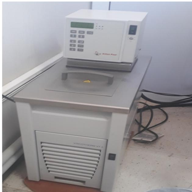
**Figure(III.10):** Bain de circulation d'un MCR.
