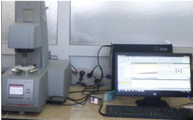
**Figure(III.19):** un MCR302 mis en marche.
