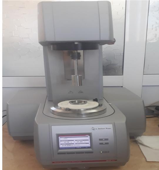
**Figure (III.8) :** Rhéomètre Modular compact 302.
