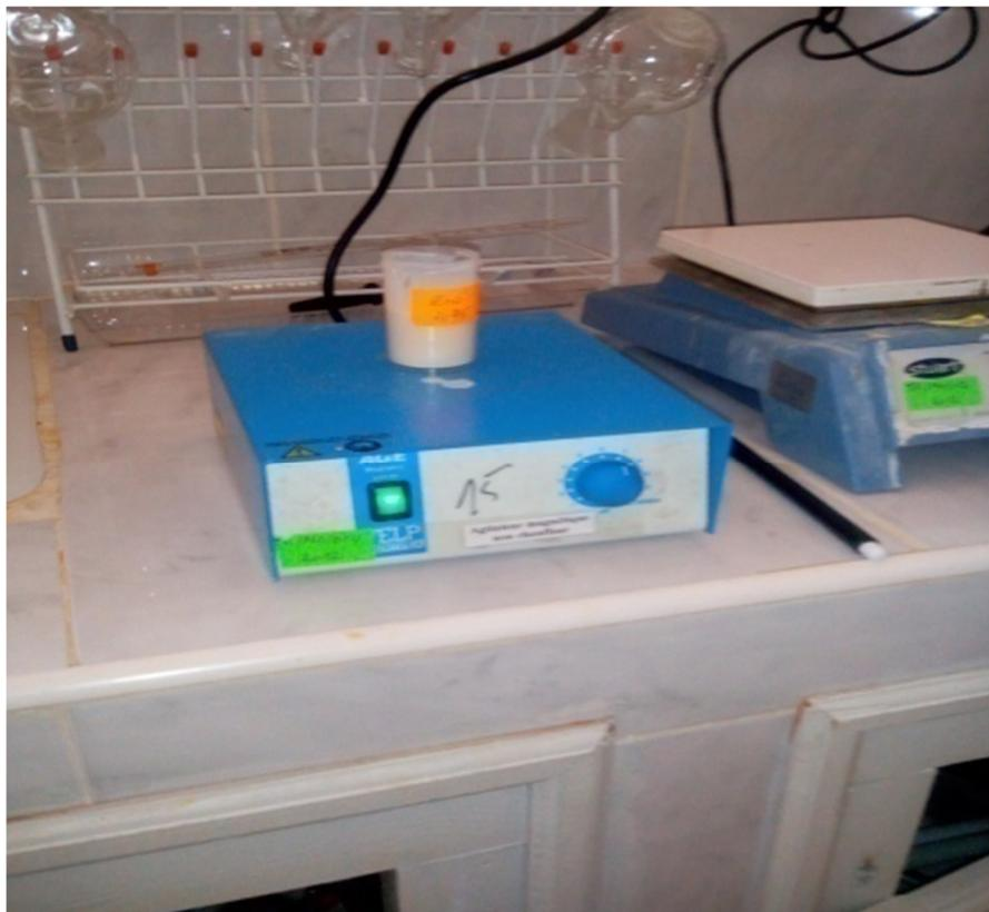
**Figure(III.6):** un agitateur magnétique.
