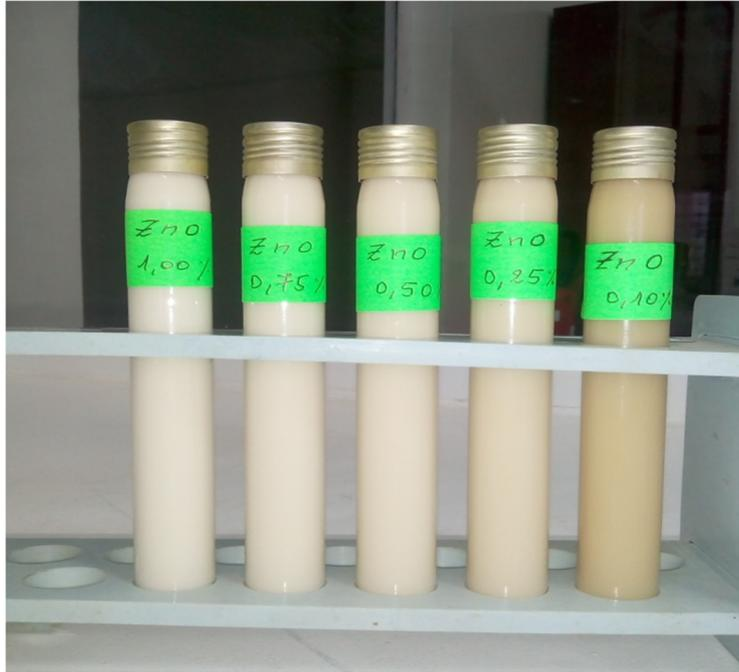
**Figure(III.7):** Photographie des échantillons du nano-lubrifiant (l'huileSAE10w40et le ZnO).
