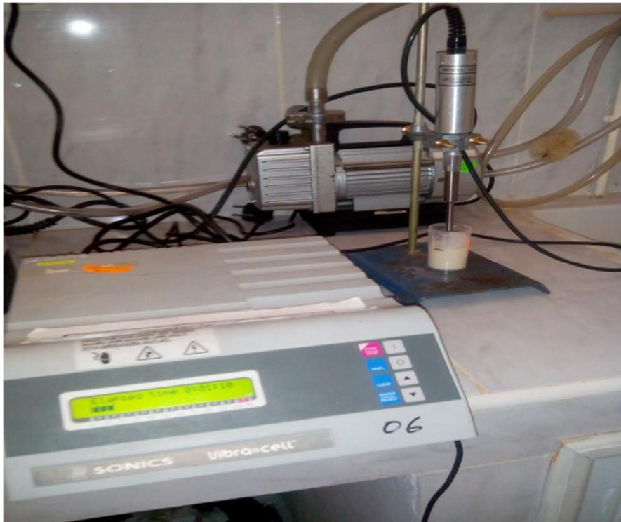
**Figure(III.5):** Homogénéisateur à ultrason.
