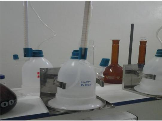
**Figure 15.** Mesure de l'acidité
