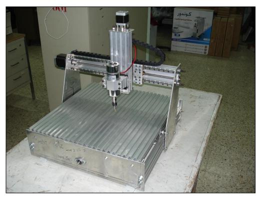
Figure 3.19 : Bâti de la machine-outil réalisée (Vue de face).
