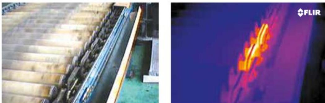
**Figure II.16 :** Image visible et thermique de rouleaux surchauffés d'un tapis convoyeur [42].
