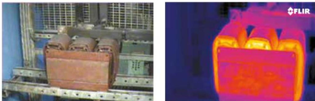
**Figure II.15 :** Image visible et thermique d'un transformateur triphasé [42].
