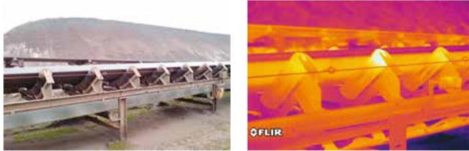
**Figure II.17 :** Image visible et thermique d'un roulement à billes qui surchauffe et devrait être remplacé [42].
