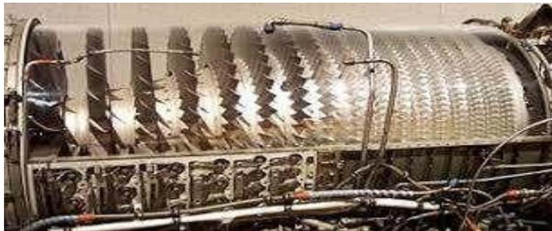
Figure I.4: Vue d'un compresseur axial.
