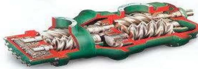
Figure I.17 : schéma de compresseur double vis.
