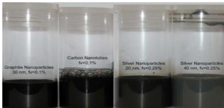
**Figure II.1:**échantillons de nano-fluides représentatifs testes au microcollecteur
