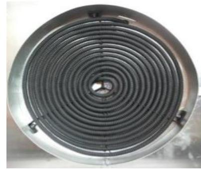
**Figure I. 19:** L'absorbeur en spirale(Velimir P et al,2018)
