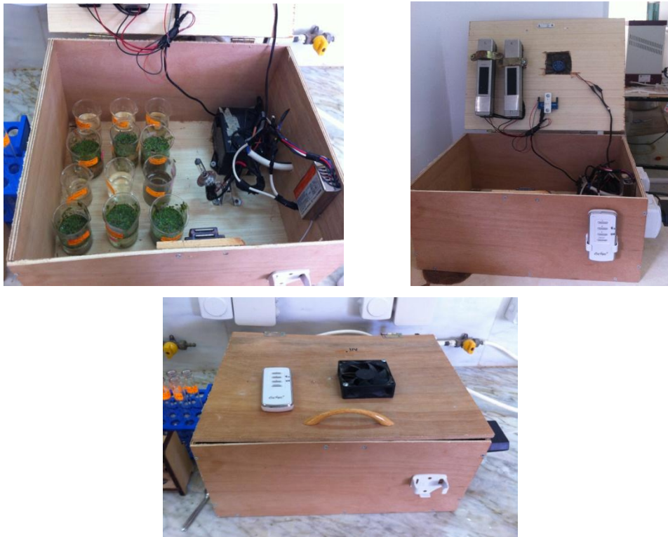
Figure 14 : Dispositif expérimental de la photocatalyse (Cliché Laaredj, 2017)
