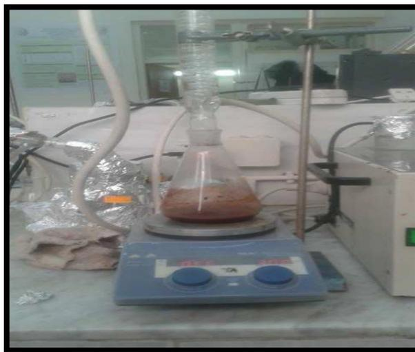
**Figure II.1 :** Dispositif expérimental de l'activation chimique des ND.
