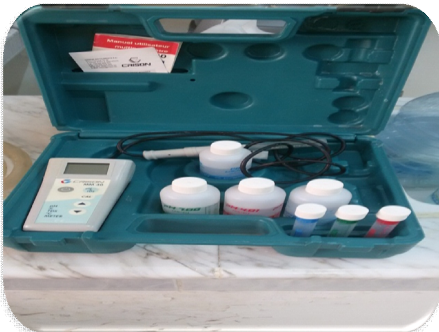
Figure n° 13: pH mètre muni d'une sonde de mesure. (Cliché: AZIBI Farid; 2017)
