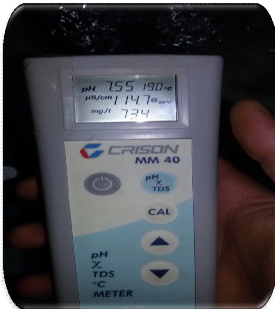
Figure n° 14: pH mètre muni d'une sonde de temperature. (Cliché: AZIBI Farid; 2017)
