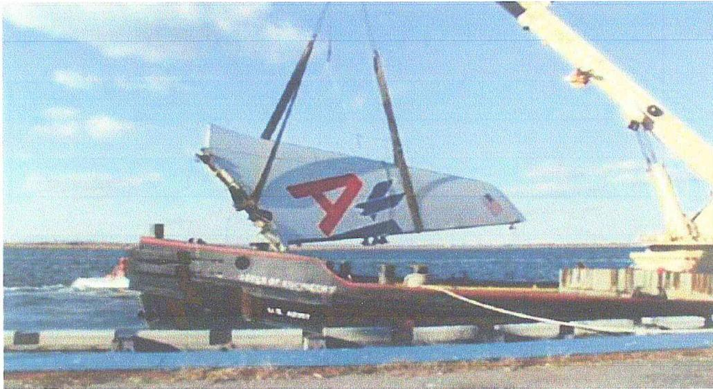
**Figure.2** : Stabilisateur vertical, qui s'est séparée du vol American Airlines 587, conduisant à un accident mortel [77].
