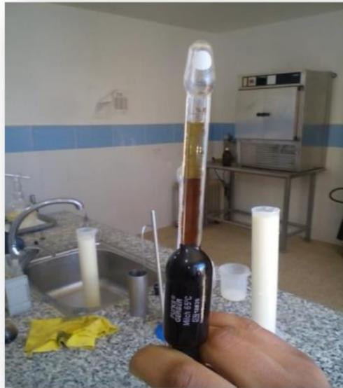
**Figure N°08.** Lecture de MG sur le butyromètre
