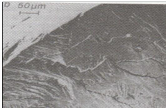
**Figure II.4 :** Rupture fragile par clivage dans un acier faiblement allié microscopie à balayage.
