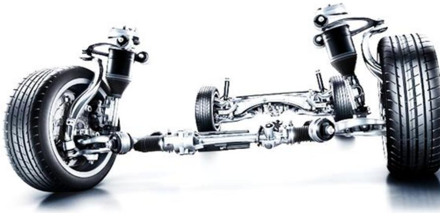
Figure I.9 : Ressort pneumatique [10].
