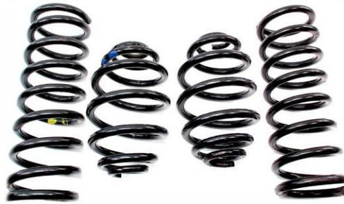
Figure I.6 : Ressorts hélicoïdaux.
