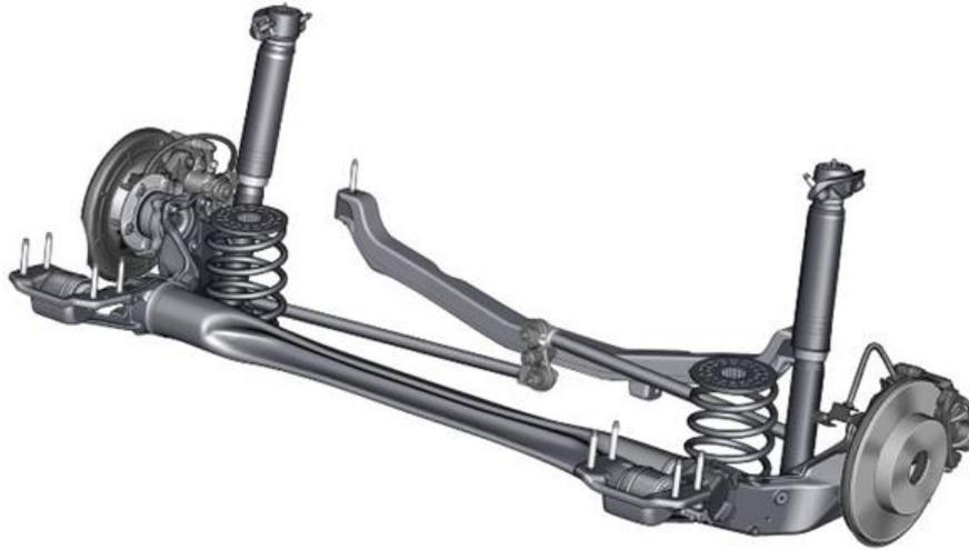
Figure I.21 : Essieu arrière déformable ou de torsion [11].
