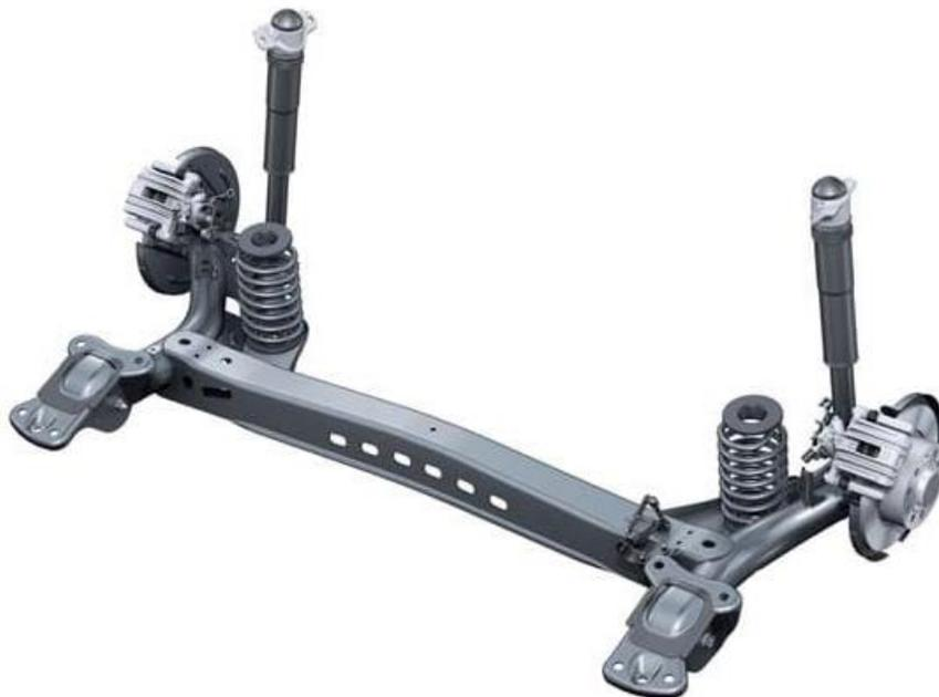
Figure I.20 : Essieu semi-rigide en H [14].
