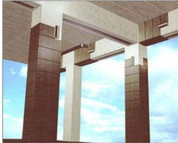
*Figure III.9: Principales applications industrielles de renforts composites selon la technique EBR (External Bonded Reinforcements) poteau (confinement), renfort de poutre en flexion, et à l'effort tranchant. [Cours MDC II].*
