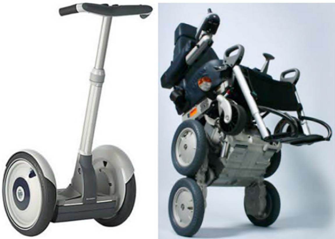
Fig I.3 Segway i180 series (gauche) et iBot 4000 (droite)
