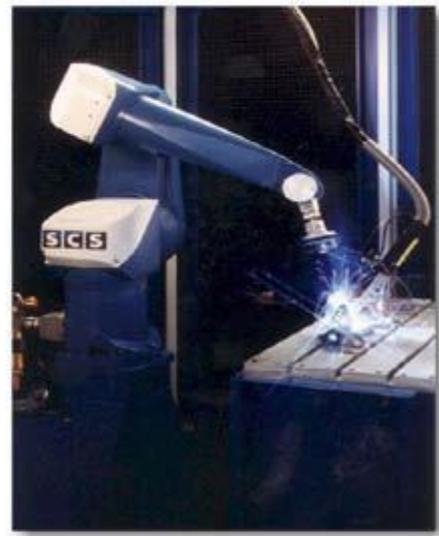
Figure.I. 30: Robot soudeurs a l'arc
