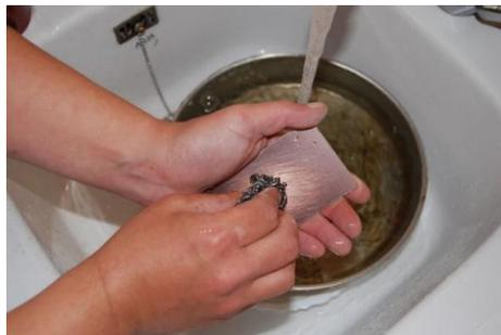
**Figure III. 11** nettoyage de la surface présensibilisée [8]
