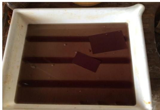
**Figure III. 14** la plaque dans le « photoresist stripper »
