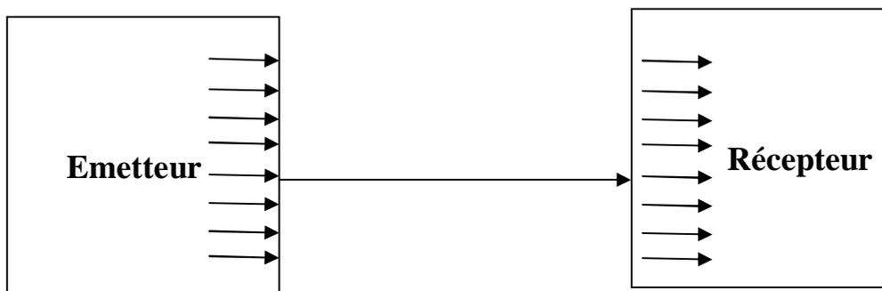
**Figure-II-2** : Schéma synoptique du type de transmission Série.
