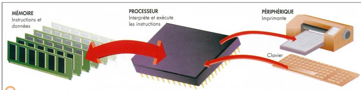
Figure-III-4 : Schéma synoptique d'un système à microprocesseur.
