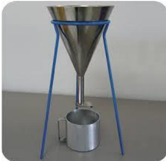
*Figure III.4. Essai de la masse volumique apparente.*
