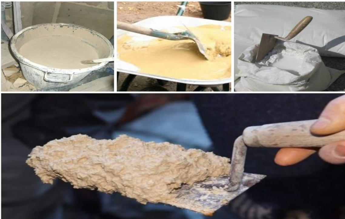
*Figure I.9. Le mortier de chaux*
