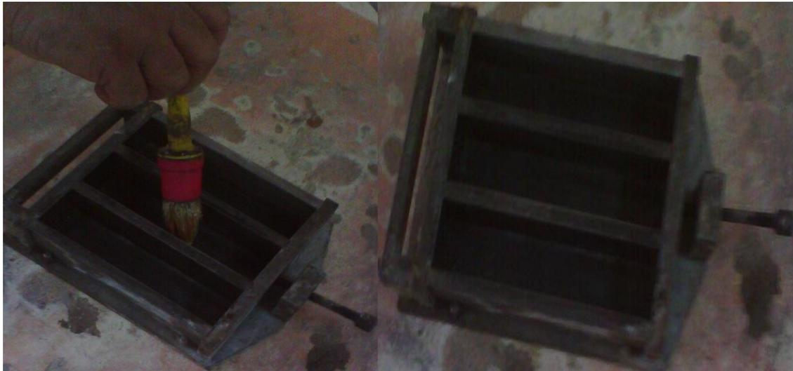
*Figure .III.11 Préparation et Huilage des moules.*
