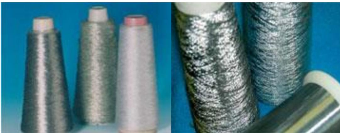
*Figure II.2 Fibre d'inox*
