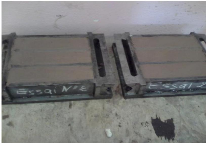
*Figure III.13 moules remplis en mortier.*
