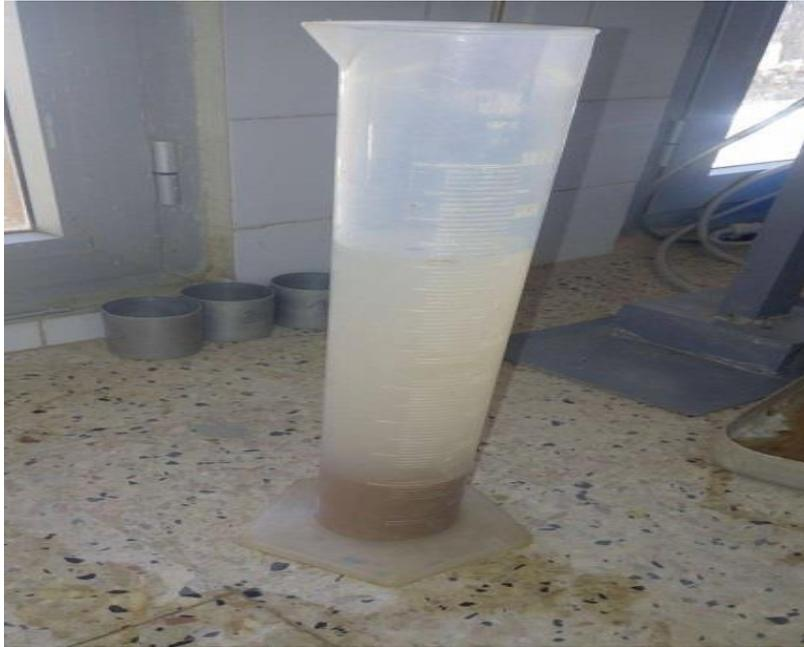
*Figure III.3. La masse volumique absolue (éprouvette graduée)*
