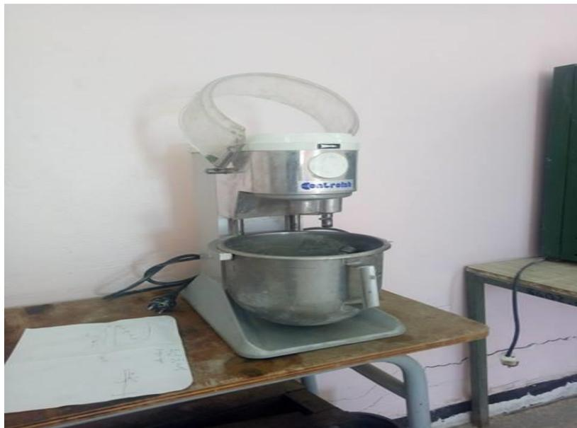
*Figure III.14 : Malaxeur pour mortier.*
