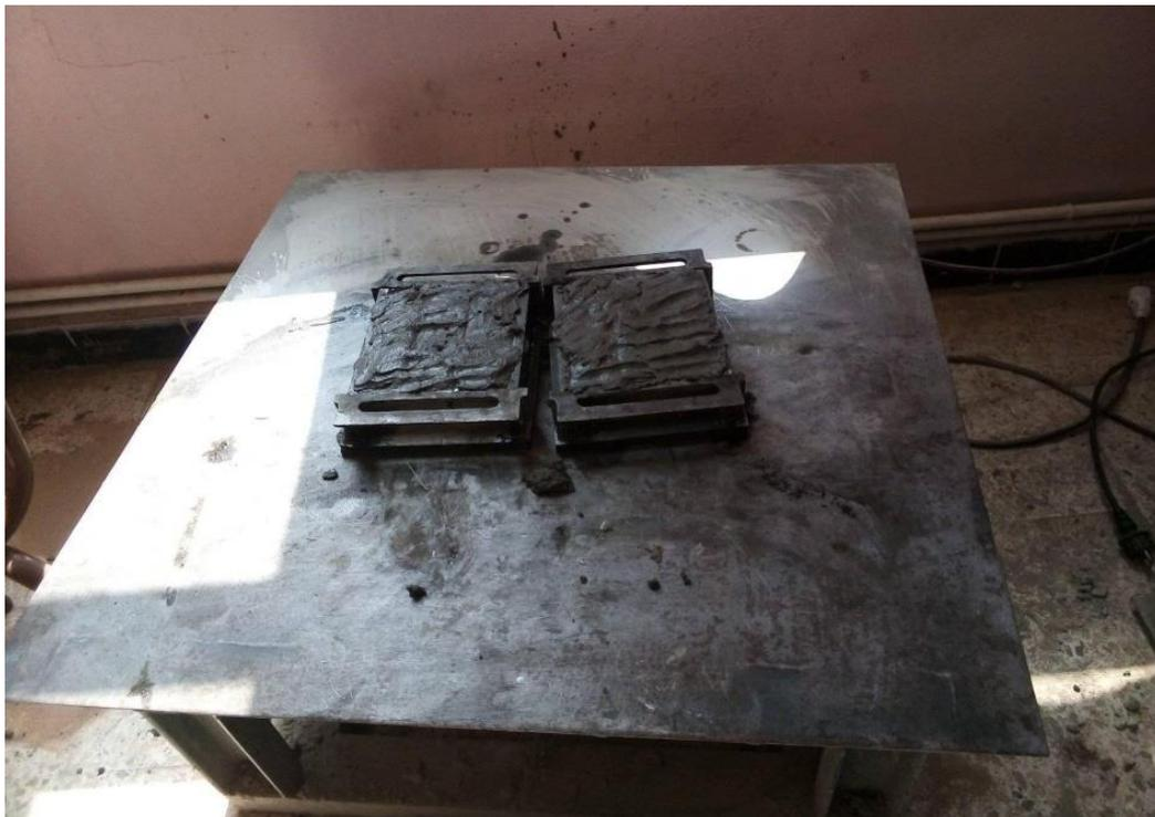
*Figure III.12. Remplissage et vibration des moules en mortier.*
