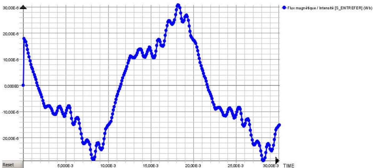
Fig.III 26 : le flux magnétique en présence du défaut
