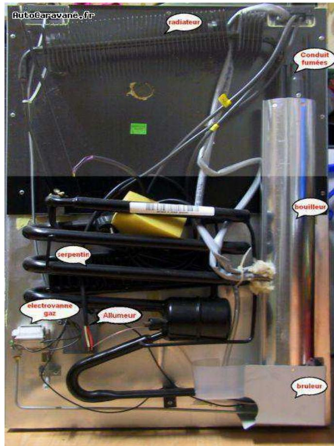
*Figure 3.2 : Composants d'un frigo à absorption.*
