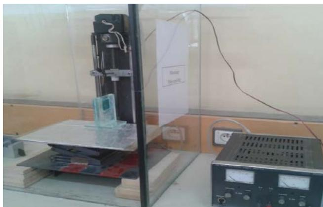
**Figure III.12.** Dispositif de dépôt « Dip-coating »
