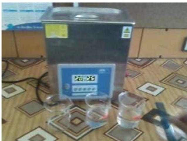
Figure III.9. Bain ultrason utilisé pour le nettoyage.
