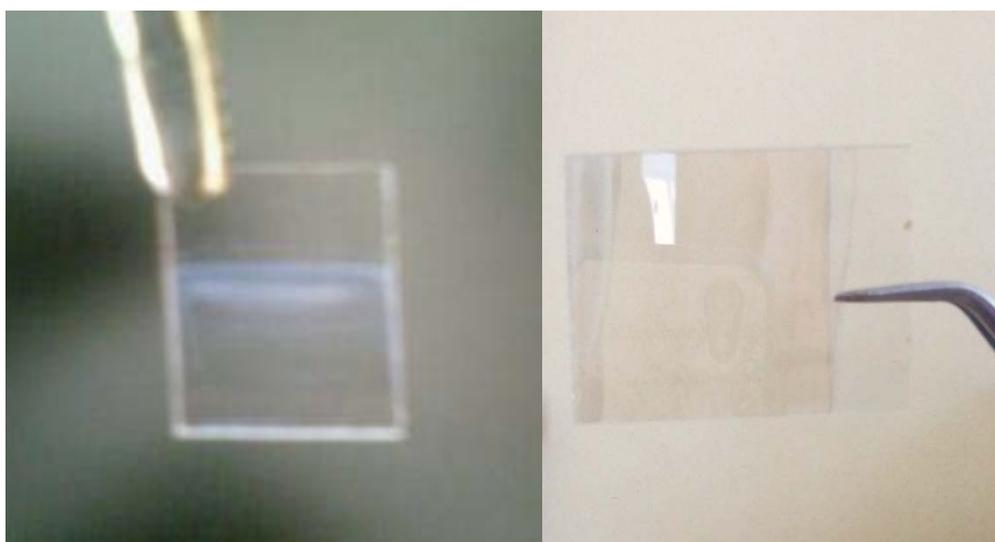
**Figure III.14.**Film mince de TiO<sub>2</sub> non dopé recuit à 500°C pendant 15 et 120 min.
