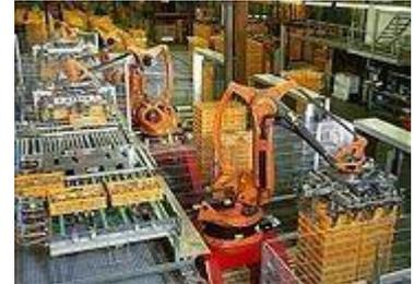
Un robot se compose d'une partie mécanique, le bras lui-même, d'une armoire de commande composée d'une unité centrale qui pilote les électroniques de commande d'un ou plusieurs axes qui en assure l'asservissement, de variateurs de vitesse et d'un langage de programmation spécialisé qui permet de commander le robot (LM développé par l'Ensimage Grenoble, langage Adept type basic) qui intègre un transformateur de coordonnées pour transformer une valeur cartésienne en données codeur du moteur.
