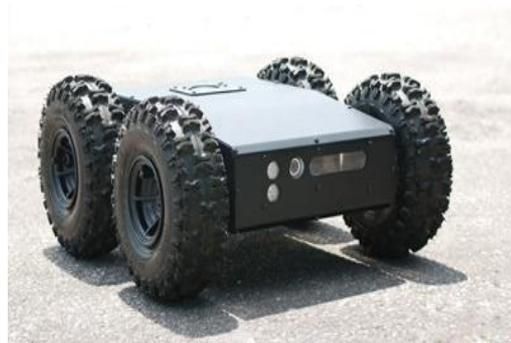
**Figure 1.7 :** Robot de type voiture.
