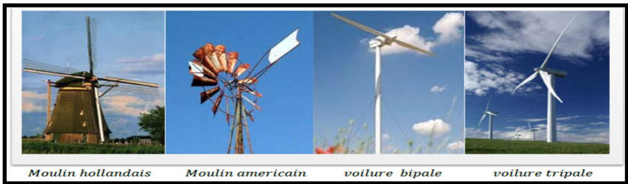
Figure I. 9 : Éolienne à axe horizontale.
