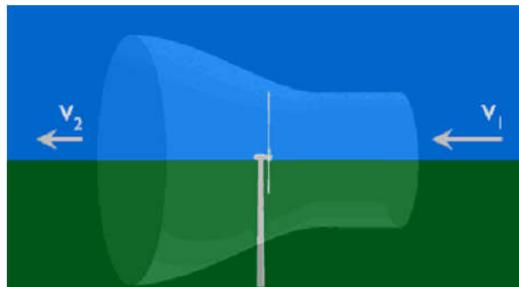
Figure II. 3 : Répartition des vitesses dans le tube de courant.
