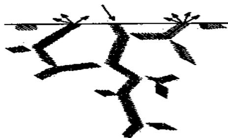
Figure. II-3 : Représentation schématique d'une cascade de collisions
