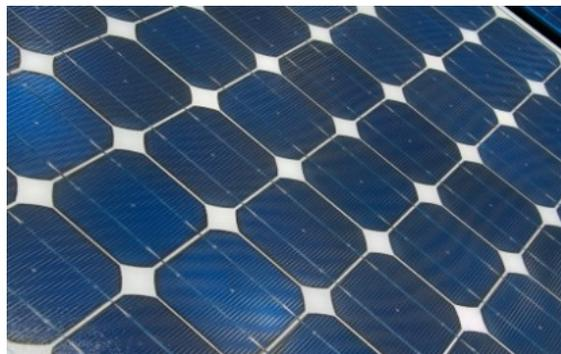
**Figure II-2 Schéma représentatif d'une plaque de silicium monocristallin [6].**
