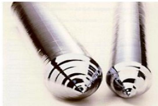
Figure II-4 Schéma représentatif des lingots de Si monocristallin [8].
