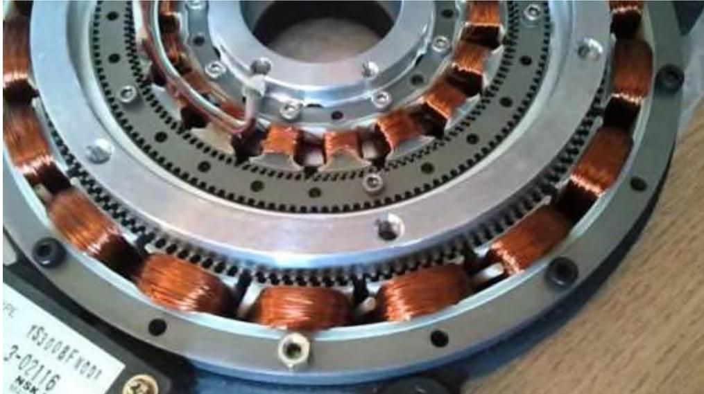
**Figure I .16 MRVDS à effet Vernier à stator externe et interne.**
