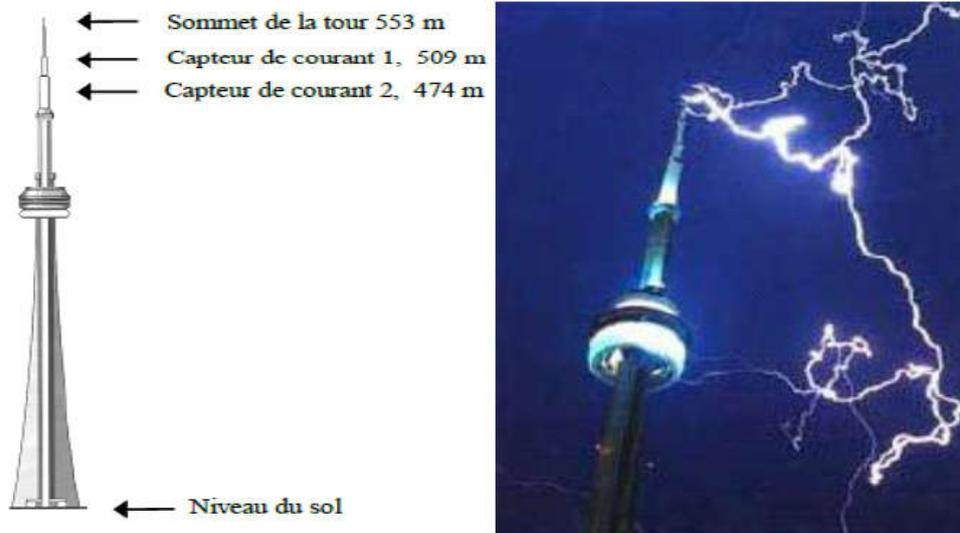
Figure I.13 : Exemple de mesure de courant de foudre en utilisant une tour instrumentée.
